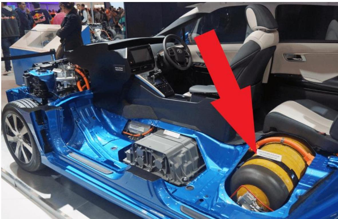
**Figura 17 - Exemplo de um tanque de armazenamento de hidrogênio.
